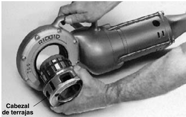
Figura 3 – Instalación del Cabezal de terrajas No. 12-R
